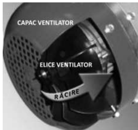
Figura 2.17 Sistem răcire motor asincron trifazat
